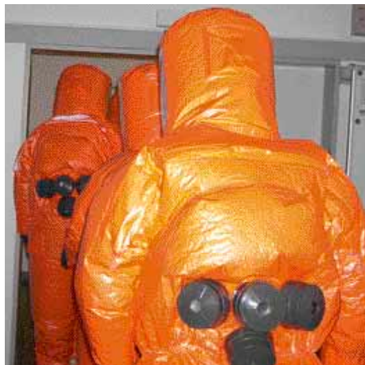
Abb. 5: Der Anzug „in Betrieb“ von hinten mit aufgeschraubten Filtern
